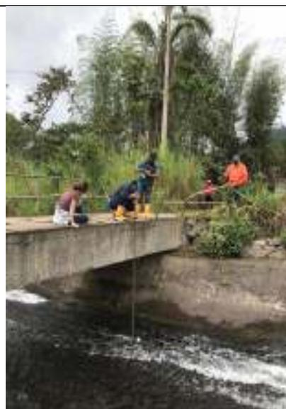
**Fotografía 10.** Aforo de medición de caudal en el canal de devolución de las aguas de la compañía Hidrotambo S.A., realizado por el INAMHI
