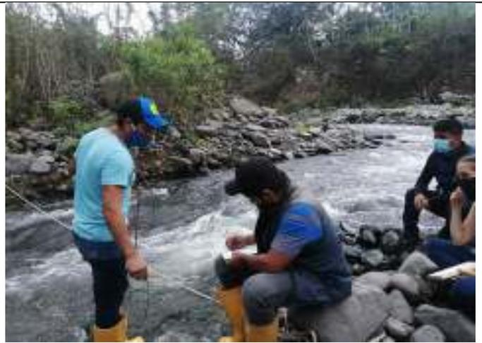
**Fotografía 8.** Aforo de medición de caudal en el río Dulcepamba, antes de la captación de la compañía aproximadamente en las coordenadas UTM WGS84 17S X: 702 122; Y: 9 784 055., realizado por el INAMHI
