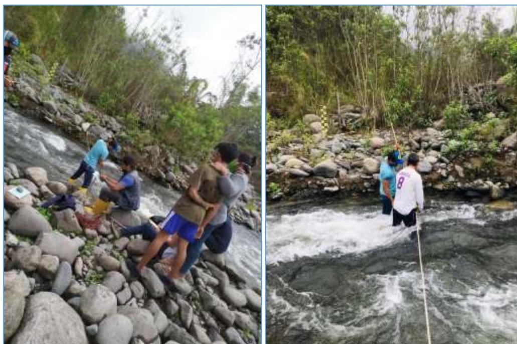
**Fig. 2** Aforo punto #1 Río Dulcepamba (captación Hidrotambo)
